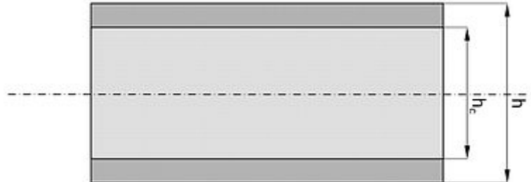
Struttura di un pannello a sandwich: uno spesso nucleo centrale polimerico è racchiuso esternamente da sottili lamine metalliche ( pelli )
